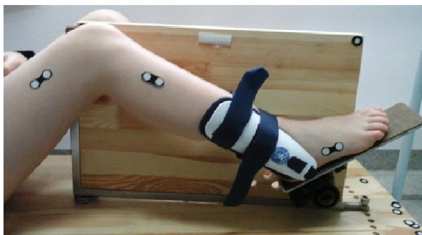
Rys. 3.10 Pomiar długości podudzia L_{oo} na podstawie wyznaczanych współrzędnych punktów obrotu stawu skokowego i stawu kolanowego (wariant I) – realizacja praktyczna
