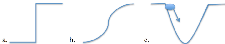
Rys. 3.2 Schemat przekroju krawędzi obrazu (a.) wywołującej energię zewnętrzną. Rozmyta krawędź obrazu (b.) po gładzeniu gaussowskim. Krawędź obrazu po gładzeniu gaussowskim i wyznaczeniu ujemnego gradientu (c). Ponadto na rysunku c przedstawiono przekrój modelu, który poprzez naturalne dążenie do minimalizacji energii przesuwa się do miejsca, w którym na rysunku a znajduje się krawędź.
