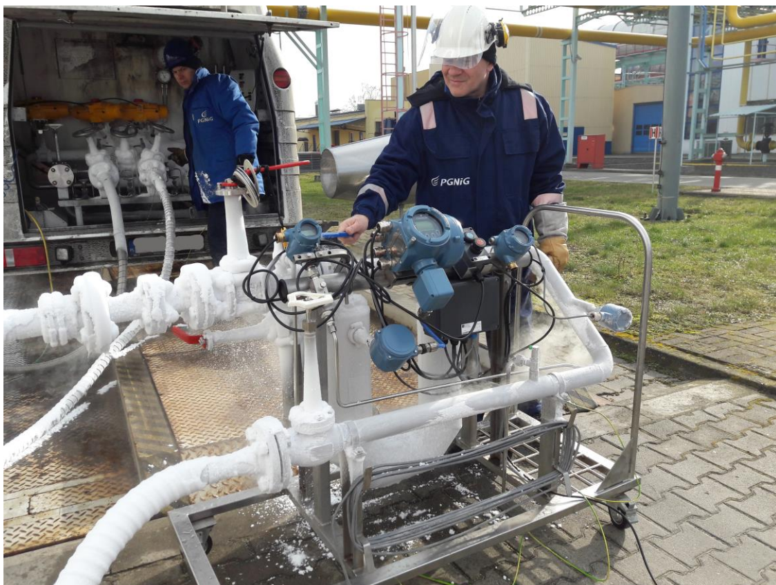
Figure 9.1: Mobile calibration stand “SMOK” (WysokieNapiecie.pl, 2018).
