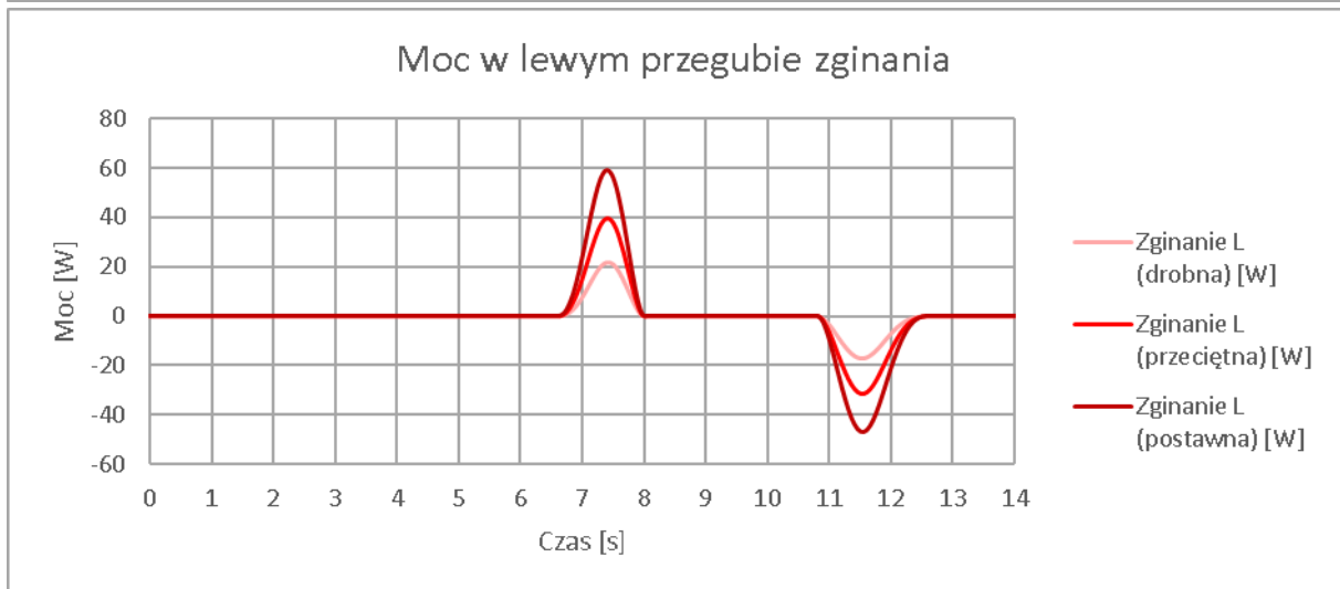
Rysunek 6.10 – Symulowane moce w ruchomych przegubach ortozy dla trzech fizjonomii. P i L – kończyna prawa i lewa.
