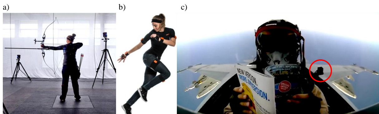
Rysunek 3.2 – Odmienne systemy śledzenia ruchu: a) system optyczny [148], b) system inercyjny z opaskami wyposażonymi w czujniki [148] i c) system magnetyczny, zaznaczony zespół czujników położenia helmu [108].
