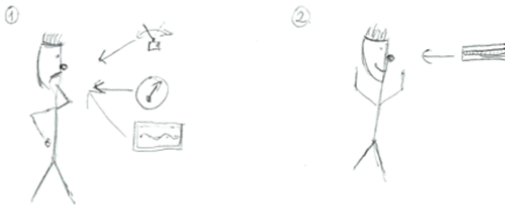
Rysunek 28: Najważniejszą zaletą Centrum Wizualizacji Bodźców jest znaczne uproszczenie nauki wykonywania testów układu autonomicznego przez pacjenta. W klasycznym (1) podejściu dla każdego z testów dedykowane było osobne urządzenie. (2) Zaproponowane rozwiązanie integruje funkcję wszystkich wskaźników w jednym urządzeniu.
