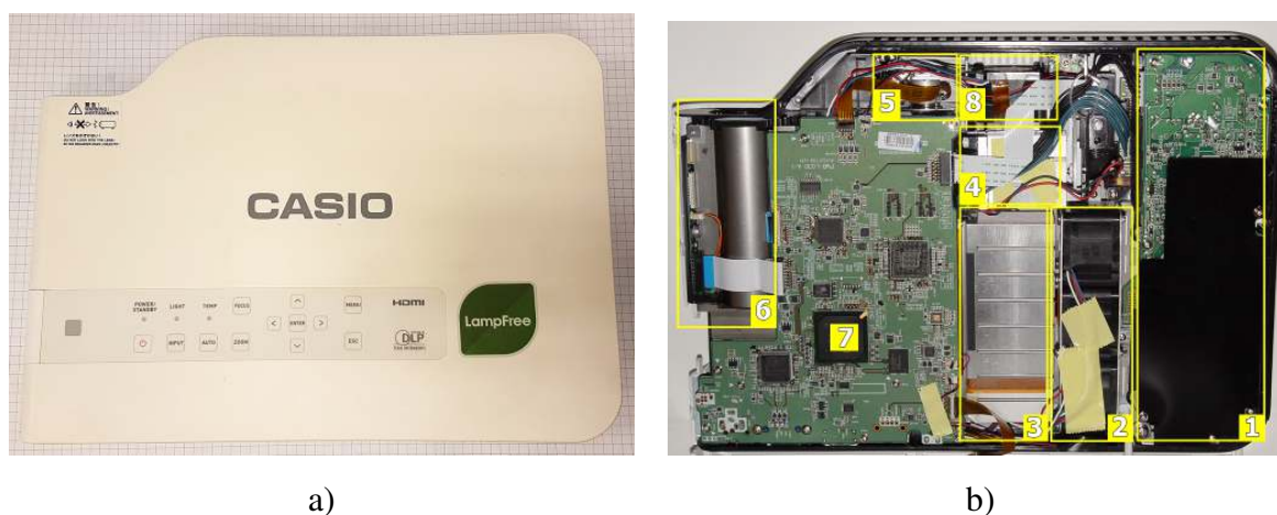
Rysunek 5.11: Projektor Casio XJ-A252. a) Wygląd projektora. b) Wygląd projektora ze zdjętą górną pokrywą. Na zdjęciu zaznaczono: (1) zasilacz, (2) wentylatory chłodzące matrycę niebieskich diod LED, (3) moduł matrycy niebieskich diod LED z radiatorem, (4) moduł czerwonej diody LED z radiatorem, (5) koło barwne, (6) obiektyw projekcyjny, (7) procesor DLP na płycie głównej oraz (8) moduł chłodzący czerwoną diodę LED.
