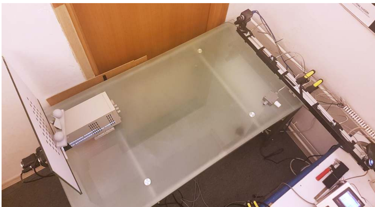
Rysunek 3.14: Stanowisko do weryfikacji modelu kompensującego wpływ temperatury na bazę mechaniczną skanera 3D.
