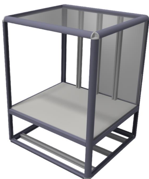
Rysunek 38. Projekt obudowy biodrukarki strumieniowej
