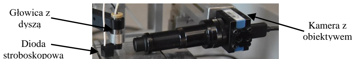
Rysunek 35. Kamera CCD do obserwacji kropli wraz z obiektywem i diodą stroboskopową
