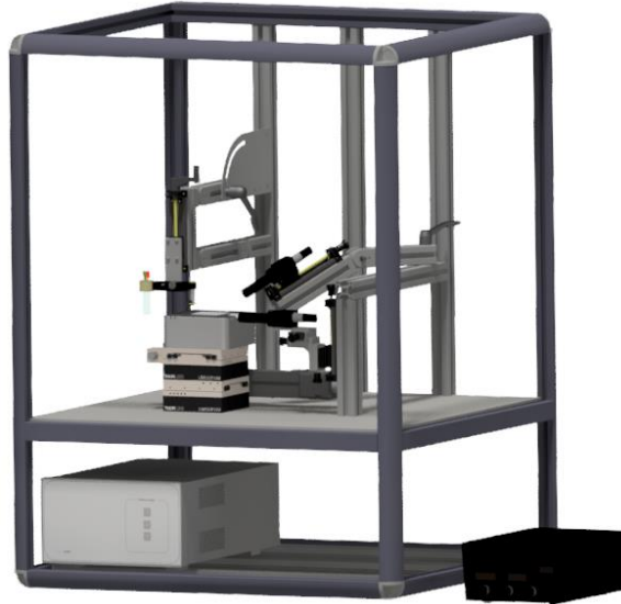
Rysunek 28. Widok ogólny stanowiska do druku strumieniowego DOD, ze sterowaniem piezoelektrycznym
