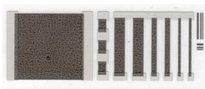
Rysunek 18. Wzór testowy do powlekania natryskowego, ze srebrowymi kontaktami [23]
