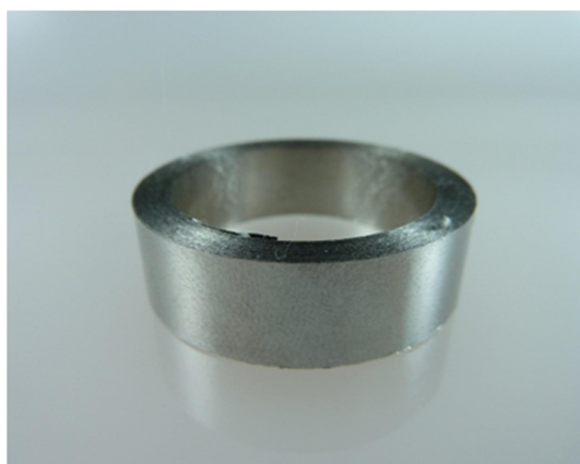
Rys. 5. Rdzeń zwijany z taśmy amorficznej
