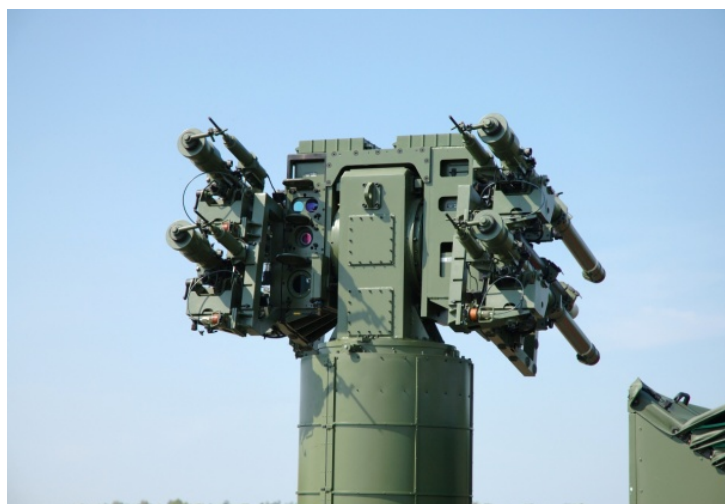
Rysunek 1.4: Wyrzutnia rakiet wyposażona w głowicę z kamerami IR i TV.
