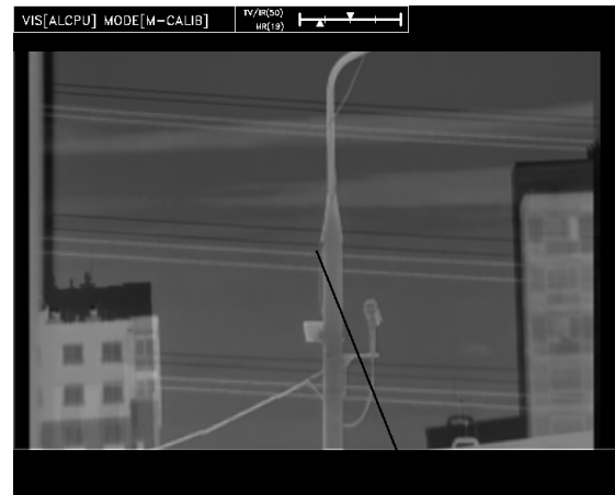
(b) Ustalone wzdłuż linii dopasowanie d_x, d_y pozwala nałożyć na siebie obiekty w bliskiej odległości od układu kamer.
