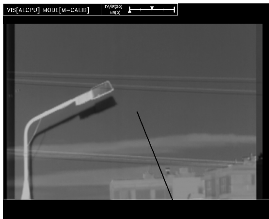
(a) Ustalone wzdłuż linii dopasowanie d_x, d_y pozwala nałożyć na siebie obiekty w dalekiej odległości od układu kamer.
