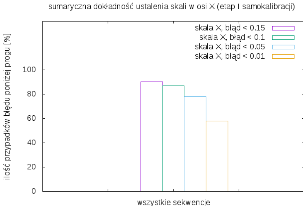
Rysunek 5.22: Sumaryczna liczba przypadków ustalenia skali w osi X z błędem poniżej określonego progu dla sekwencji testowych KAIST.
