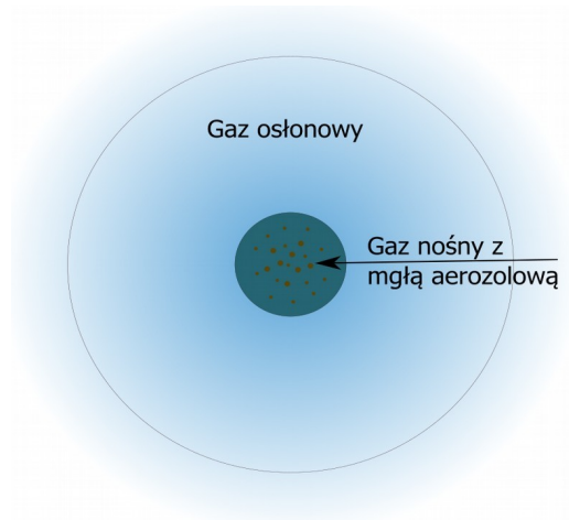
Rys. 9. Rysunek przekroju przez strugę aerozolową.
