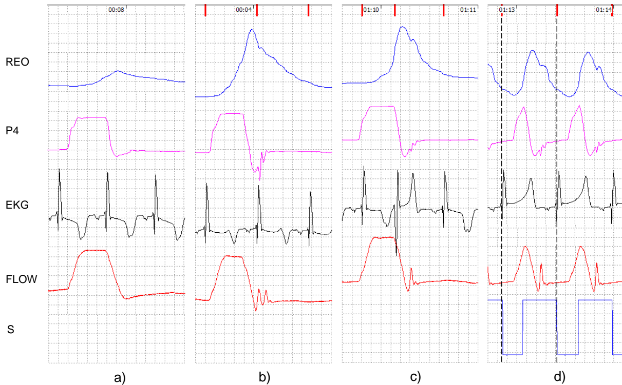
Rys. 6.10 Porównanie kształtów sygnałów zarejestrowanych podczas różnych cykli pracy komory. Linie pionowe określają cykl pracy synchronicznej.
