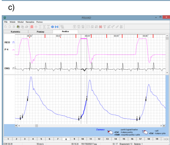
Rys. 6.5 Program BioimpCO do rejestracji, archiwizacji, wizualizacji i analizy sygnałów: okno kartoteki badań (a), okno rejestracji sygnałów (b) zapisy z eksperymentu na żywym obiekcie, okno analizy sygnałów(c), struktura bazy danych (d).
