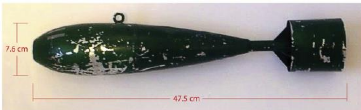
Rys. 3.2. Stalowa ćwiczebna bomba lotnicza [57]
