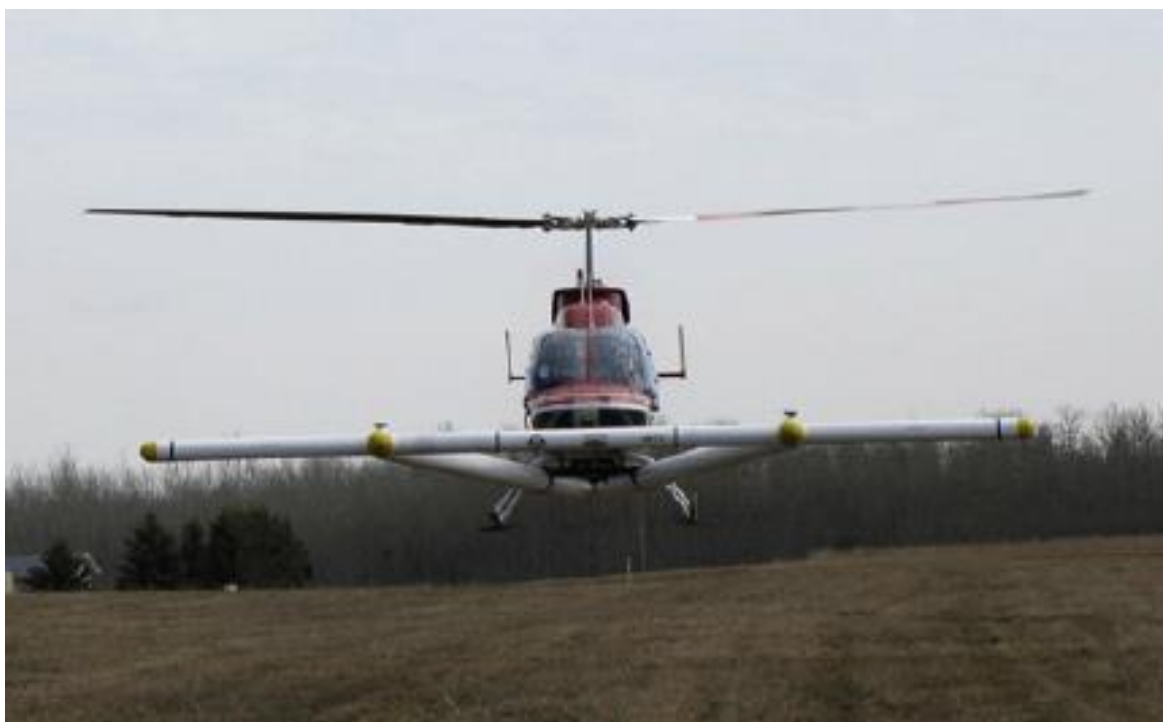
Rys. 3.1. Helikopter z zamocowanym wysięgnikiem, na którego końcach umieszczono magnetometry typu SQUID [57]
