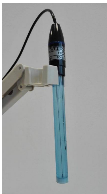
Rys. 4.2. Z lewej: Schemat budowy sondy do pomiaru pH z użyciem elektrody z membraną szklaną; z prawej: zdjęcie sondy pH-metru z membraną szklaną – model CP-505 firmy Elmetron
