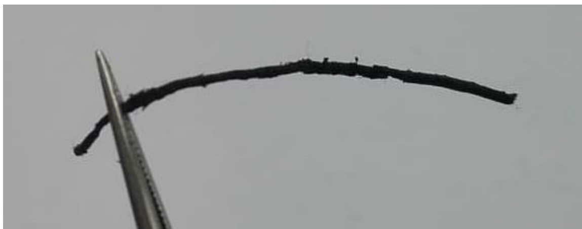
Rys. 9.7. Elektroda pH-metryczna na bazie włókna poliestrowego oraz kompozytu \text{TPU}/\text{RuO}_2/\text{GNP}
