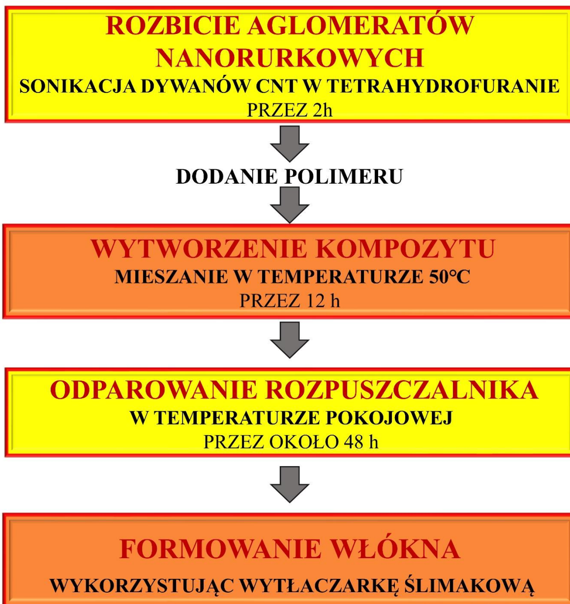
Rysunek V.III.6 Schemat opracowanej technologii wytwarzania kompozytowego włókna polimerowo-nanorurkowego.
