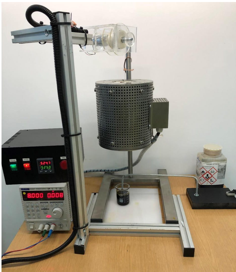
Rysunek V.II.1 Zdjęcie przedstawiające stanowisko laboratoryjne wykorzystywane do wytwarzania izolacji elektrycznej płynnymi polimerami.
