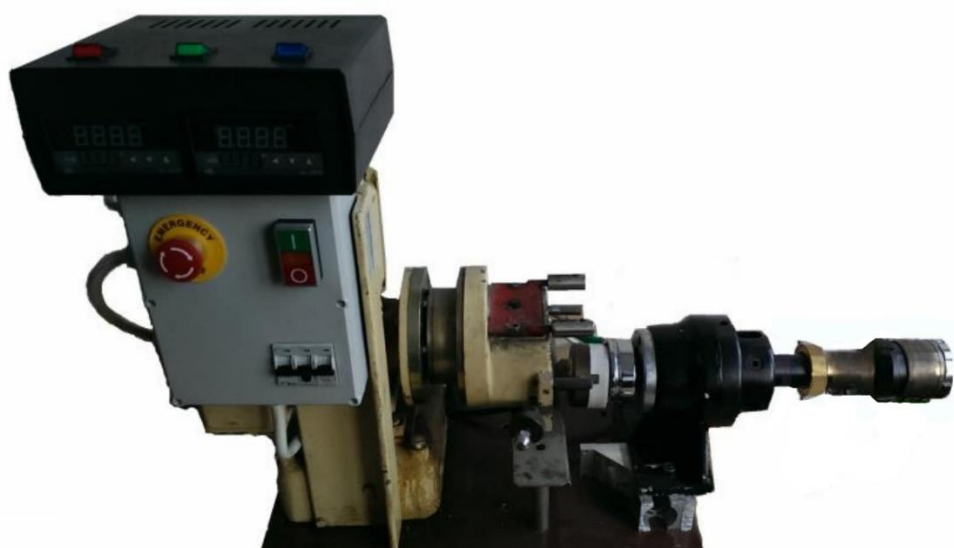
Rysunek V.III.4 Zdjęcie wytłaczarki ślimakowej wykorzystanej do wytworzenia kompozytowego włókna nanorurkowo-polimerowego
