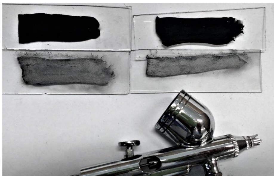
Rysunek V.2.1 Zdjęcie przedstawiające filmy nanorurkowe poddane hybrydyzacji z płatkami grafenowymi za pomocą metody natryskowej (dwie górne próbki) w porównaniu z filmami przed hybrydyzacją (próbki dolne)
