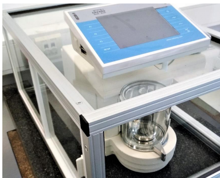
Rysunek IV.3.2 Zdjęcie ultramikrowagi wykorzystywanej podczas badań.
