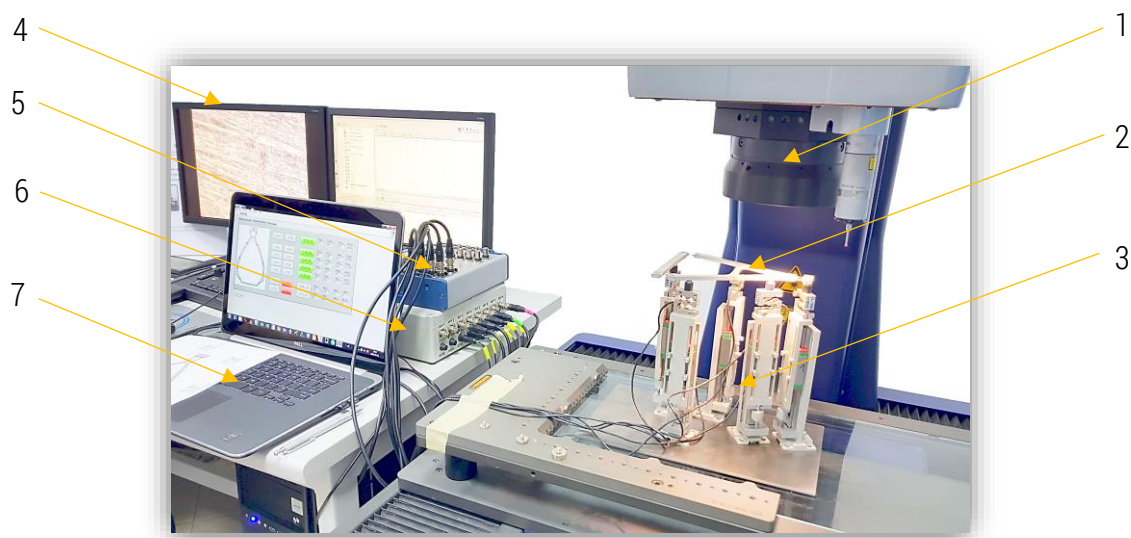
Rys. 2.23. Widok systemu adaptacyjnego mocowania na WMP. 1-WMP, 2-element mierzony, 3-podpory aktywne, 4-monitory WMP, 5-karta akwizycji danych, 6-komputer systemu mocowania, 7-elektronika czujników siły
