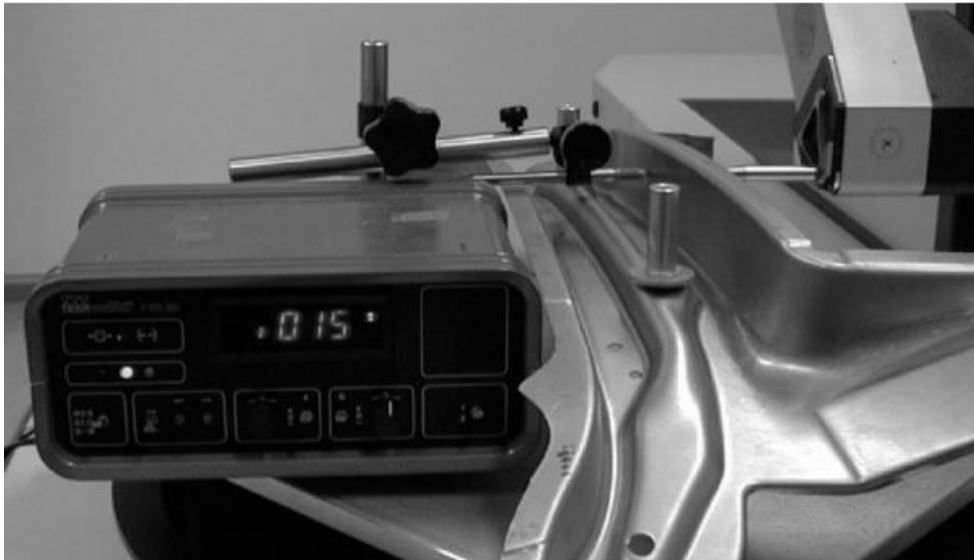
Rys. 1.9. Odkształcenie fragmentu karoserii w wyniku działania nacisku pomiarowego [86]
