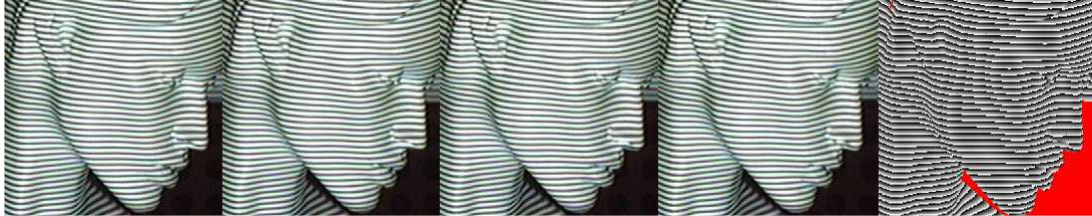
Rys. 12 Sekwencja czterech obrazów sinusoidalnych przesuniętych w fazie kolejno: 0, \frac{\pi}{2}, \pi, \frac{3}{2}\pi oraz wyznaczona faza modulo 2\pi . Źródło: [67].
