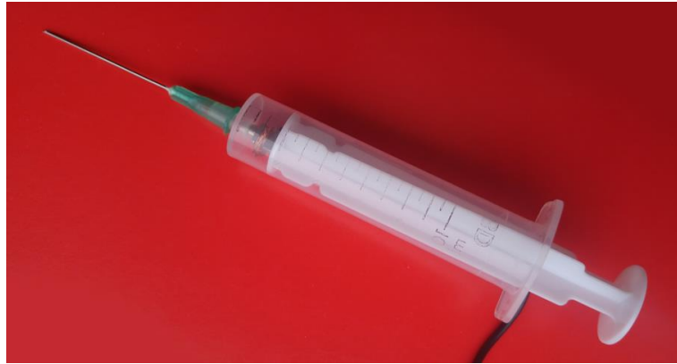
Rys. 40 Sonda w kształcie strzykawki do detekcji nakłuć.
