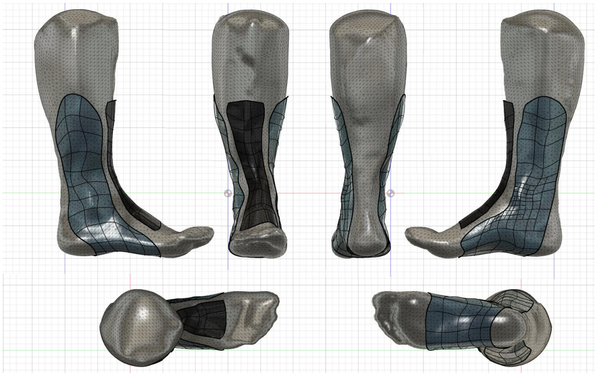
Rycina 18 Modelowanie swobodne kształtu stabilizatora w wersji bez zapiętka. Źródło własne.
