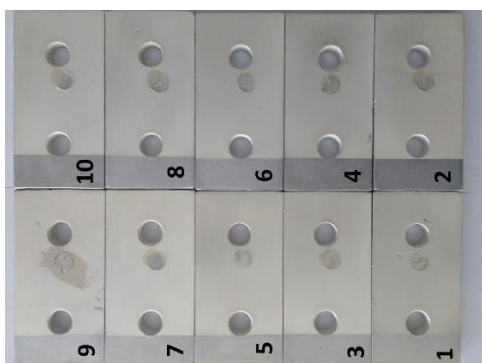
Rys. 89. Widok warstw srebrowych po badaniu ASTM D4541.
