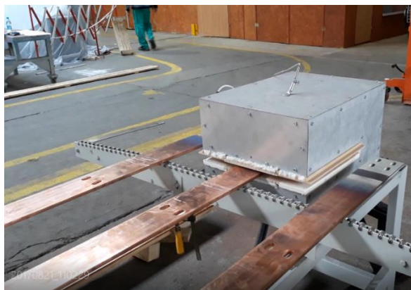
Rys. 118. Piec taśmowy podczas wypalania próbek.
