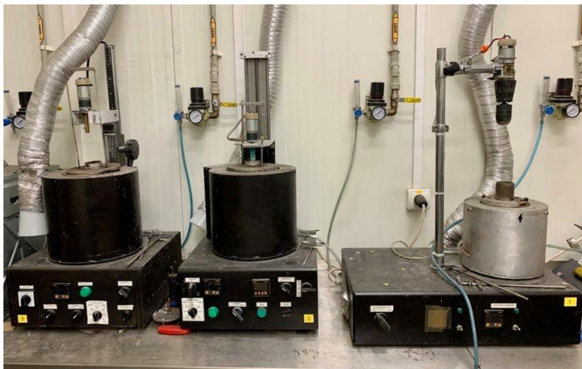
Rys. 112 Reaktory termiczne do redukcji prekursora nanoproszku srebra w skali przemysłowej.
