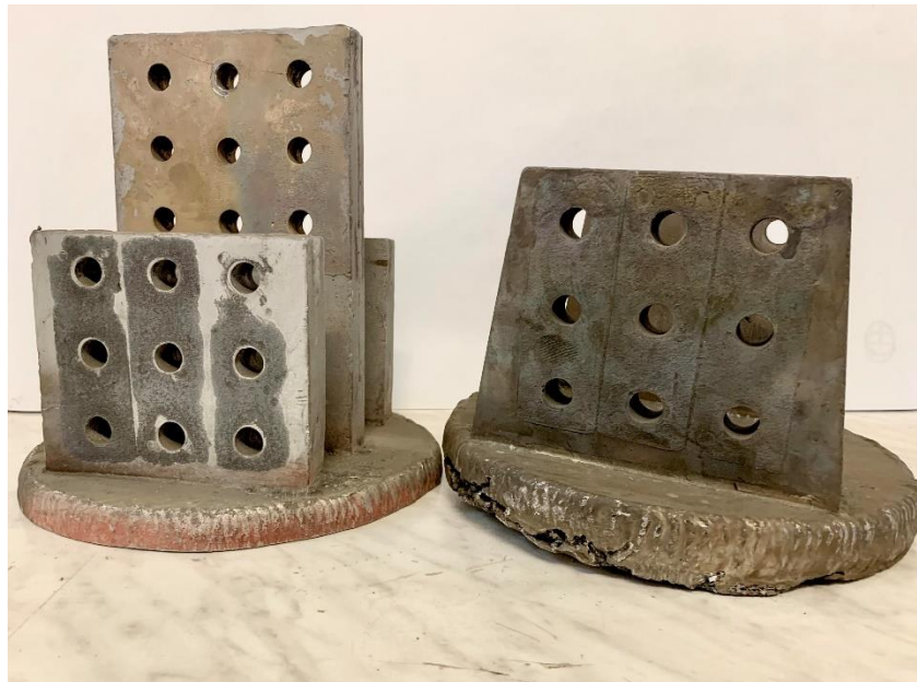
Rys. 4. Uszkodzone elementy zestykowe szyno-torów prądowych.
