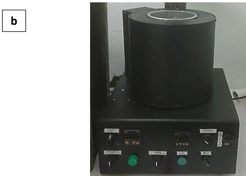
Rys. 55. Schemat reaktora do rozkładu termicznego prekursora srebra technicznej – a. Reaktor srebra technicznej – b.
