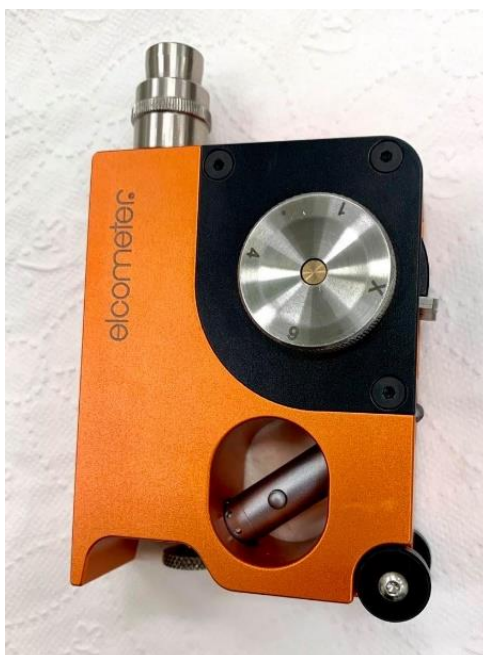
Rys. 86. Przyrząd do wykonywania siatki nacięć metodą ISO 2409.
