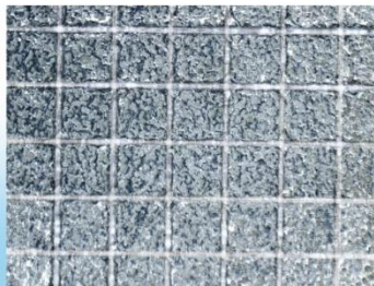
Warstwa srebra na aluminium - test adhezji zgodnie z PN ISO 2409: klasa 0
